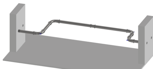
Rys. 7. Przebieg rury z dodatkowym łącznikiem (dodanie węzła)
