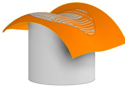
Po poleceniu Zamień powierzchnię (górną walca na powierzchnię dodatkową)
